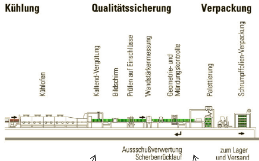
Industrielle Glasproduktion am Beispiel der Behälterglasfertigung (Quelle: Saint-Gobain Oberland)
