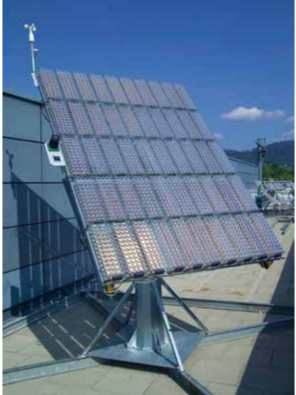
FLATCON®-MODULE AUF EINER NACH- FÜHREINHEIT AM FRAUNHOFER ISE. FLATCON® MODULES ON A TRACKER AT FRAUNHOFER ISE.
