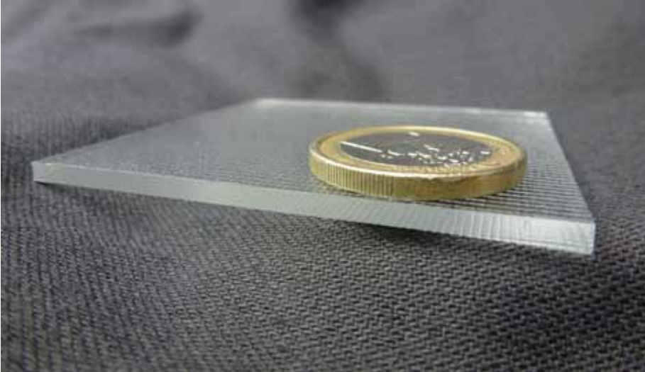
CENTROSOL - DAS NEUE DÜNNGLAS EIGNET SICH BESONDERS FÜR GLAS-GLAS-MODULE. CENTROSOL - THE NEW THINGLASS PERFECTLY SUITS GLASS-GLASS-MODULES
