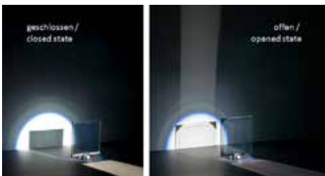
Funktionsprinzip der Mikrospiegel Arrays (geschlossener und geöffneter Zustand) working principle of Micro Mirror Arrays (closed and opened state)
