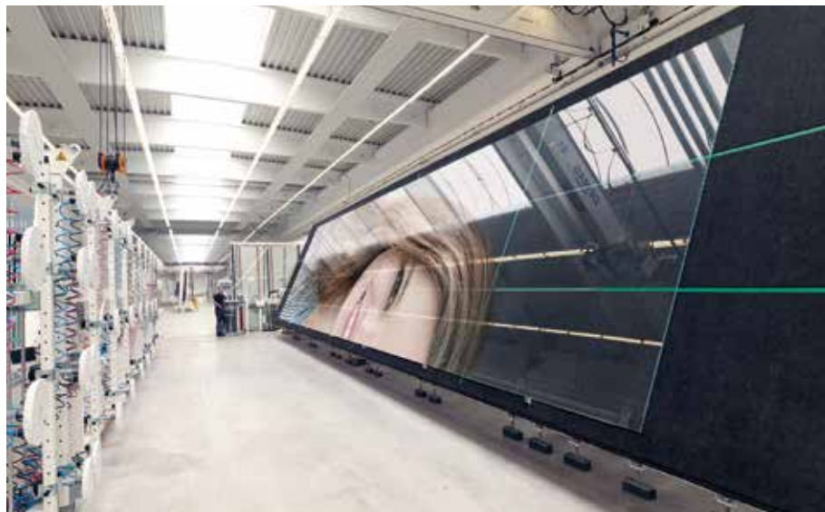
sedak betreibt den weltweit größten keramischen Digitaldrucker und bedruckt damit Scheibenformate von bis zu 3,20 m x 15 m. The world's largest digital ceramic printer for printing on glass panes with dimensions of up to 3.20 m x 15 m is operated by sedak.
