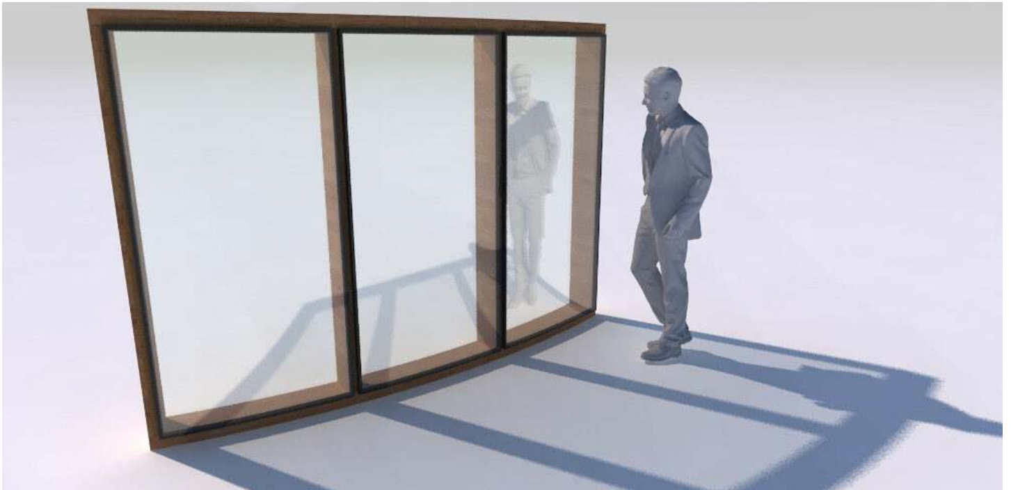
Ausschnitt einer gekrümmten Fassade mit kaltgebogenen Isolierverglasungen. Section of a curved façade with cold-bent insulating glazing. (© Johannes Giese-Hinz, TU Dresden)
