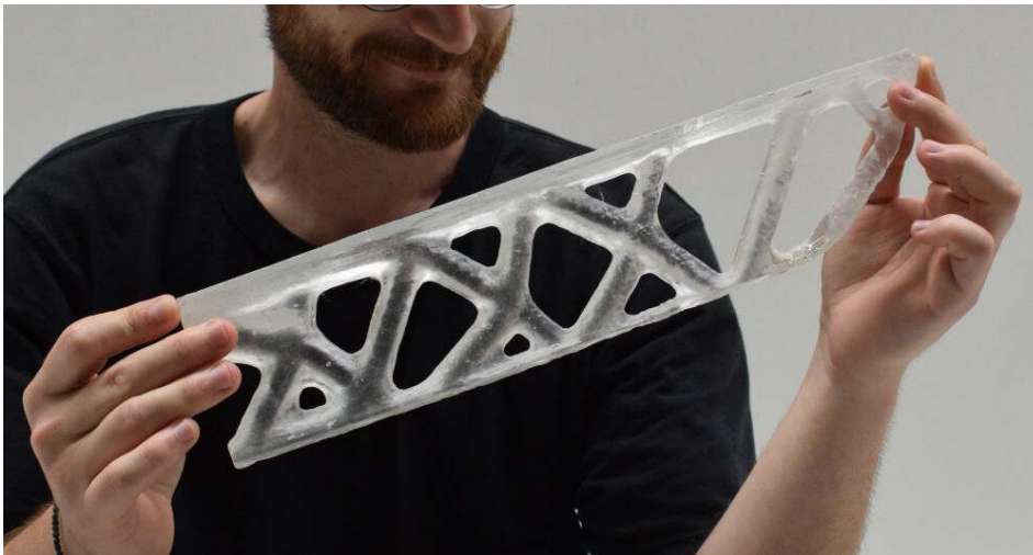
Topologisch optimierter Glasbalken, der im Ofen in einer Sandform gegossen wurde. (© Menandros Ioannidis) Topologically optimised glass beam kiln-cast in a sand mould. (© Menandros Ioannidis)
