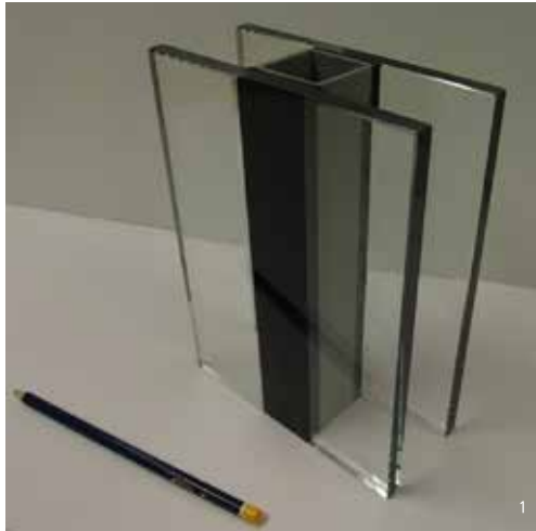
Verbundglaseinheiten in (1) kleinem Maßstab und zentralem Wirbelsäulenkern und (2) maßstabsgetreu und Kantengerahmenkern, letzterer wird während des Montageprozesses gezeigt.
