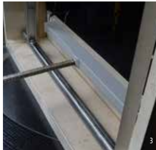
(1 + 2) Render und Modell der adaptiven Dünnglassassade von Ribeiro Silveira, Klein und Louter. Render and mockup of Adaptive Thin Glass Façade by Ribeiro Silveira, Klein and Louter. (3) Biegetest von dünnem Glasverbund mit 3D-gedruckten Kernmustern von Neeskens, Turrin und Louter. Bending test of thin glass composite with 3D printed spacer pattern by Neeskens, Turrin and Louter. (4) Muster eines dünnen Glasverbunds mit 3D-gedruckten Kernmustern von Neeskens, Turrin und Louter. Sample of a thin glass composite with 3D printed spacer pattern by Neeskens, Turrin and Louter.
