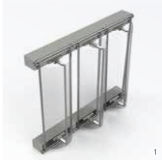
(1 + 2) Render und Modell der adaptiven Dünnglassassade von Ribeiro Silveira, Klein und Louter. Render and mockup of Adaptive Thin Glass Façade by Ribeiro Silveira, Klein and Louter. (3) Biegetest von dünnem Glasverbund mit 3D-gedruckten Kernmustern von Neeskens, Turrin und Louter. Bending test of thin glass composite with 3D printed spacer pattern by Neeskens, Turrin and Louter. (4) Muster eines dünnen Glasverbunds mit 3D-gedruckten Kernmustern von Neeskens, Turrin und Louter. Sample of a thin glass composite with 3D printed spacer pattern by Neeskens, Turrin and Louter.
