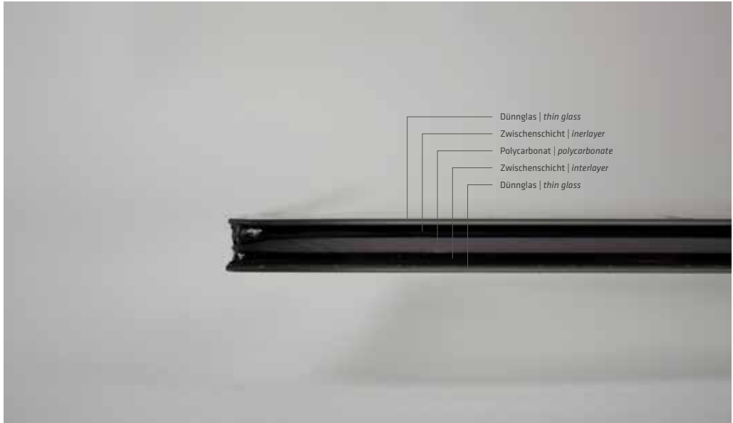
Querschnitt einer Dünnglas-Polycarbonat-Verbundtafel Cross-section of a thin glass-polycarbonate composite panel
